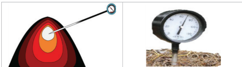
그림 31. 퇴비더미 내 중앙지점 온도 측정(좌) 및 철봉 온도계(우)
